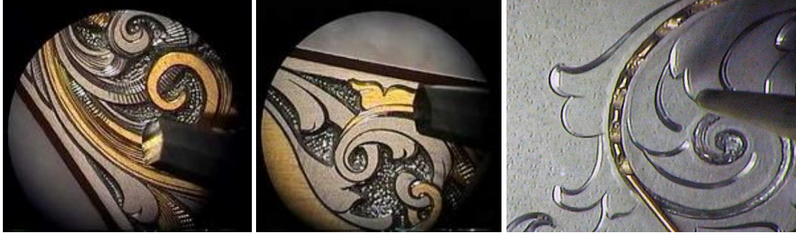
Görsel 1: Çelik uçlu kalemler yardımıyla gümüş metali üzerine günümüz altın plaka ve tel kakma uygulamaları (Url 1, 2, 3).
